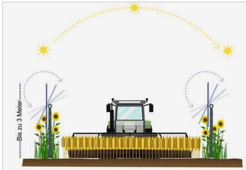
Systematischer Aufbau Agri-PV-Tracker-System, Quelle: RS Invest GmbH & Co. KG (Vorhabenträger)
